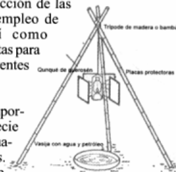
Fig. 71. Esquema de una trampa de luz con querosén.
