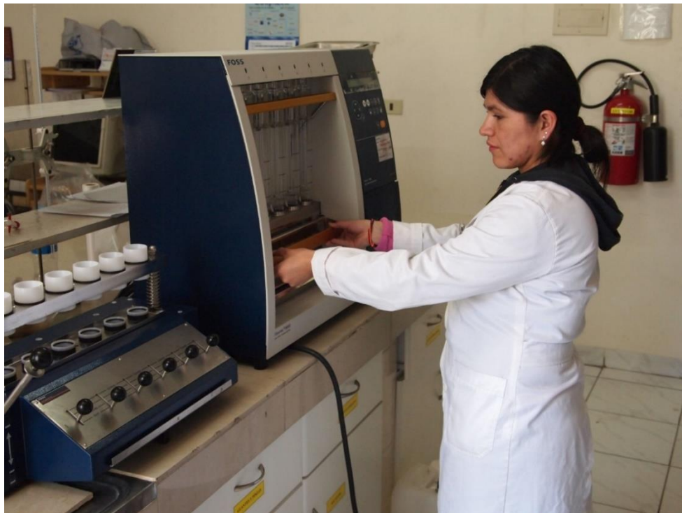
Análisis de fibra en el equipo FiberTech para alimentos de la ACE en el Centro de Alimentos y Productos Naturales CAPN-UMSS Fuente: Archivo CAPN (2025)
