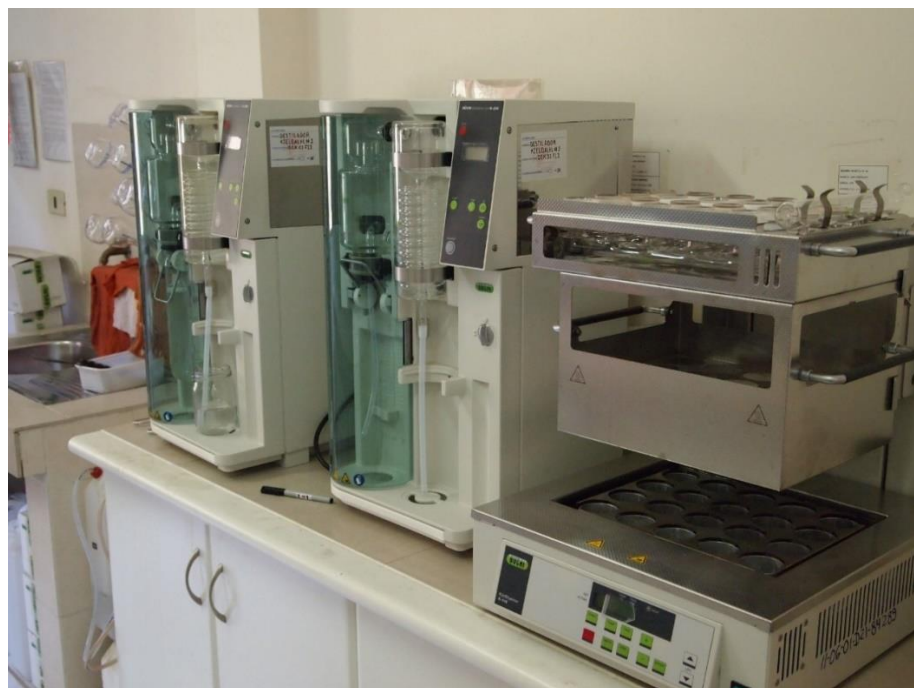
Análisis de nitrógeno total en el equipo Kejdahl para la determinación de proteína de alimentos de la ACE en el Centro de Alimentos y Productos Naturales CAPN-UMSS Fuente: Archivo CAPN (2025)
